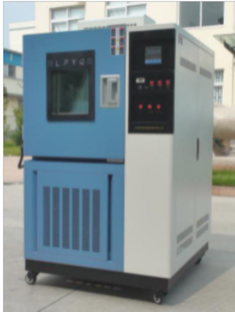
高低温试验箱：适用于工业产品高温、低温的可靠性试验。对电子电工、汽车摩托、航空航天、船舶兵器、高等院校、科研单位等相关产品的零部件及材料在高温、低温（交变）循环变化的情况下，检验其各项性能指标。产品具有较宽的温度控制范围，其性能指标均达到国家标准GB10592-89高低温试验箱技术条件，适用于按GB2423.1□GB2423.2□电工电子产品环境试验 试验A□低温试验方法，试验B□高温试验方法》对产品进行低温、高温试验及恒定温热试验。产品符合GB2423.1□GB2423.2□GJB150.3□GJB150.4□IEC□MIL标准。
